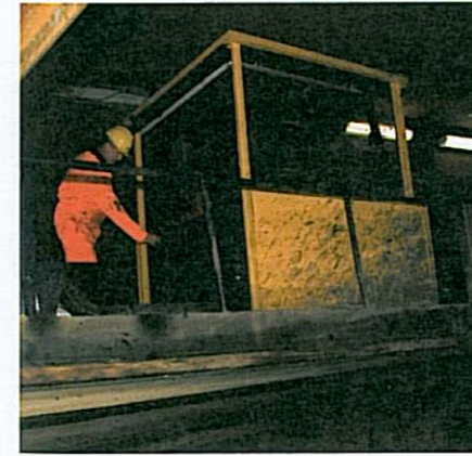
In de BomBox ligt een klein baggervartaug met een cabine die de machinist beschermt tegen eventueel rondvliegende scherven.
